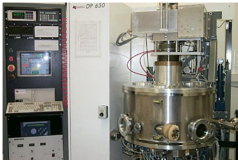
Figure II.18 : Photo du système de pulvérisation magnétron utilisé.
