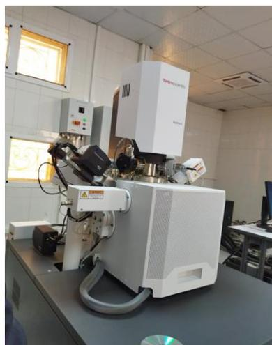
**Fig. IV.15** Microscope électronique à balayage
