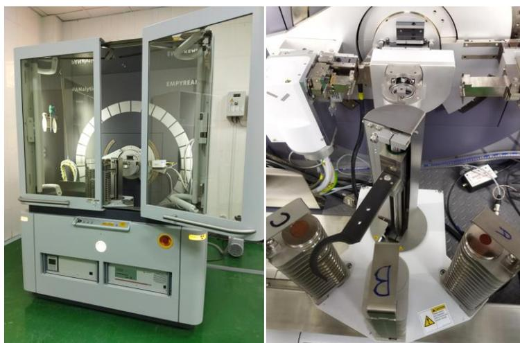
**Fig. IV.14** Diffractomètre de rayons X
