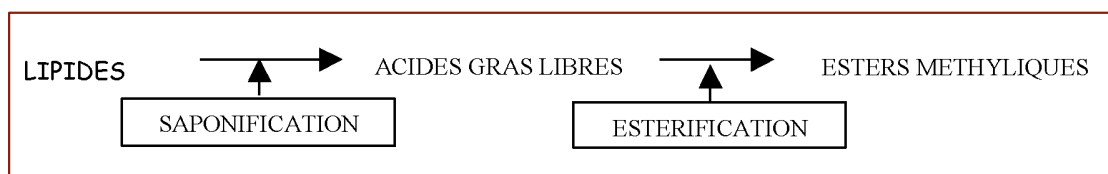
Figure 19. Principe de la dérivation par estérification (Anses, 2011).
