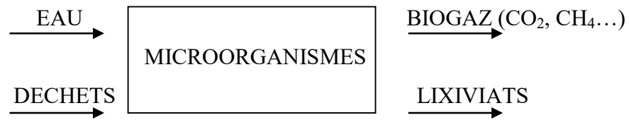
Figure 4. Le bioréacteur «décharge »
