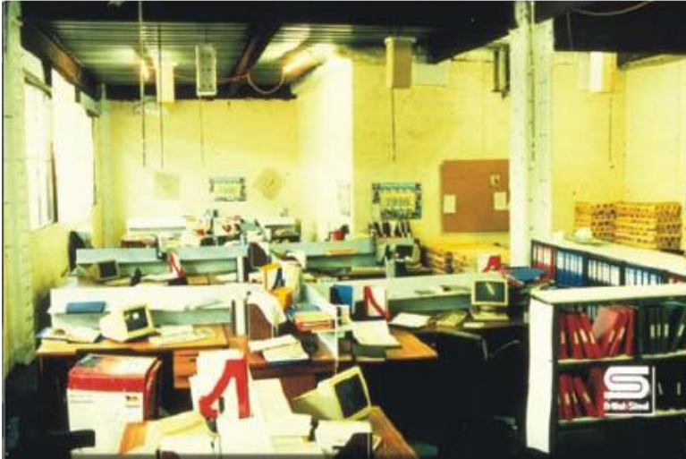
Figure (1-17)a - Compartiment de l'essai du bureau reconstitué du bâtiment de Cardington [11].
