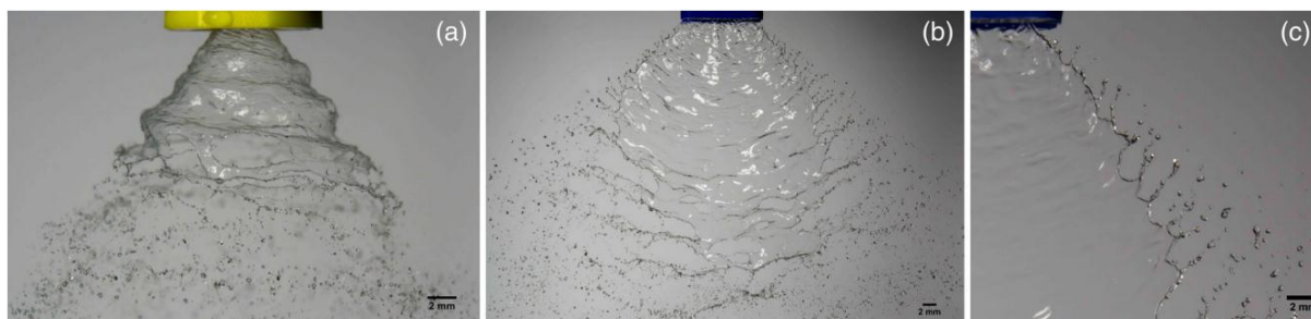
Fig. I.22 (a) Spray conique avec une pression de service de 2,0 bar. (b) jet plat à 2,0 bar, avec un claquement et une rupture près du bas de l'image. (c) Photo agrandie du jet plat à basse pression (1,0 bar).
