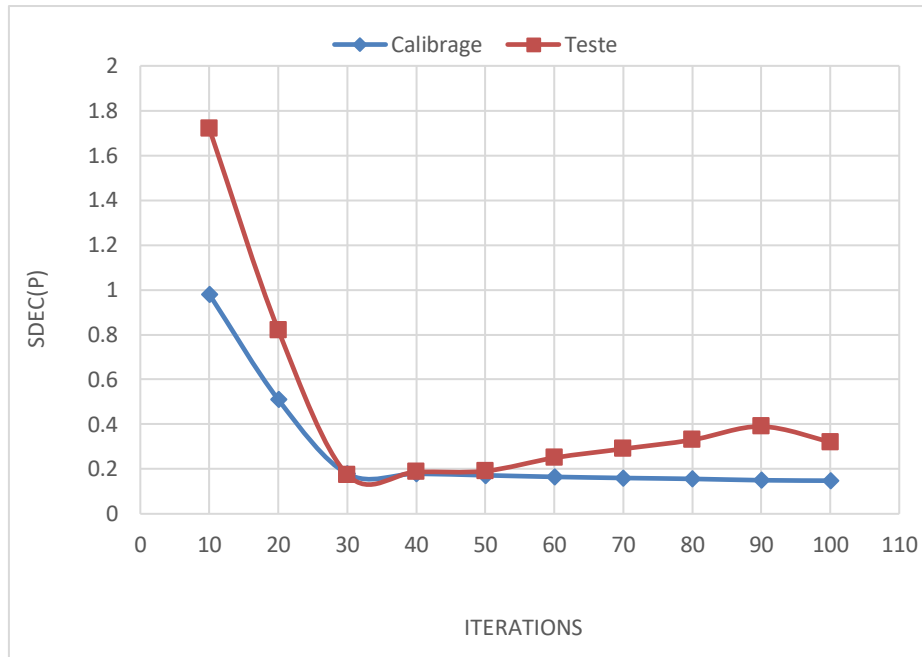
Figure 22 : Evolution des erreurs SDEC et SDEP en fonction du nombre d'itérations.
