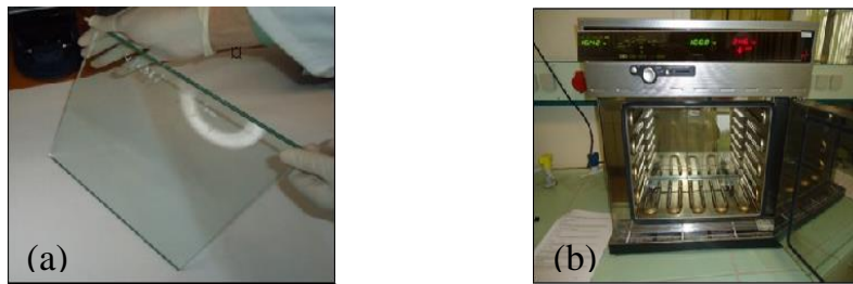
Figure IV. 33: Montage expérimental de test à haute température (LICB/DAC/CRD-GN), (a) éprouvette, (b) étuve de traitement.
