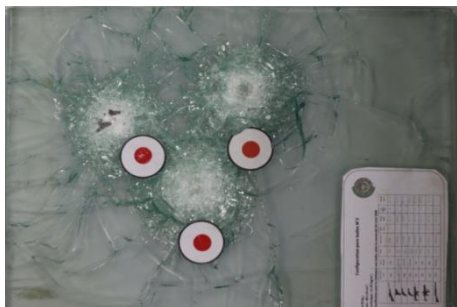
Figure IV. 27: Échantillon N°2 après trois tirs (arme AK-47, 7.62x39 mm).
