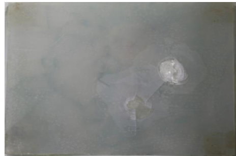
Figure IV. 30: Échantillon N°5 après trois tirs (arme AK-47, 7.62x39 mm).
