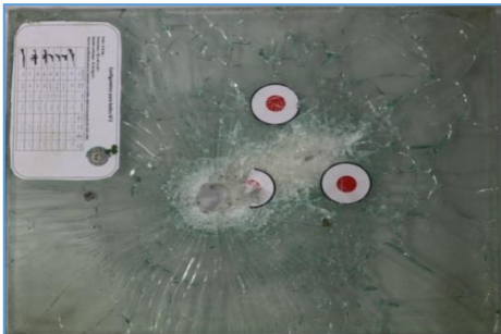
Figure IV. 27: Échantillon N°2 après trois tirs (arme AK-47, 7.62x39 mm).
