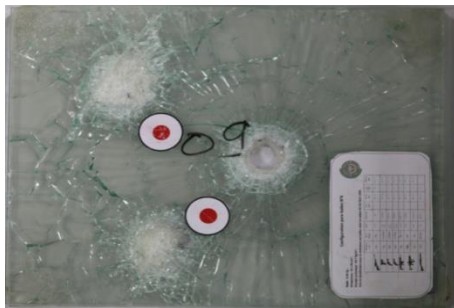
Figure IV. 31: Échantillon N°6 après trois tirs (Arme AK-47et BERETTA).
