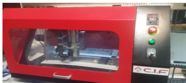
Figure III. 17 Technodrille 03 utilisé pour le découpage de l'éprouvette.
