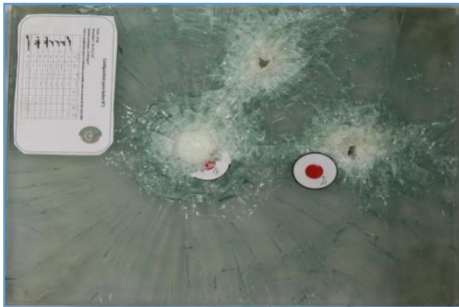
Figure IV. 26: Échantillon N°1 après trois tirs (arme AK-47, 7.62x39 mm).
