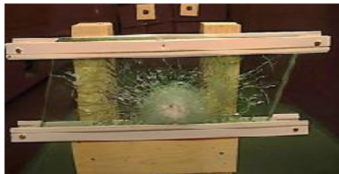
Figure IV. 24: Impact sur l'échantillon N°2 (face avant) après le premier tir (arme AK-47).
