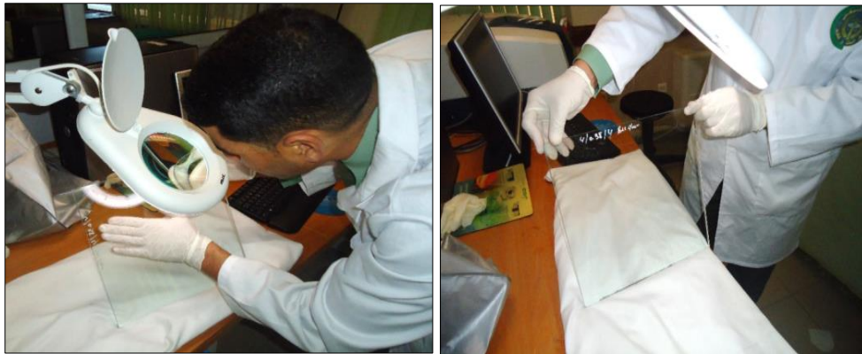
Figure IV. 35: inspection d'échantillon après le test d'humidité
