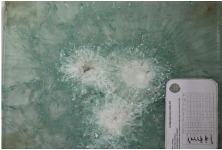
Figure IV. 29: Échantillon N°4 après trois tirs (arme BERETTA 9 mm).
