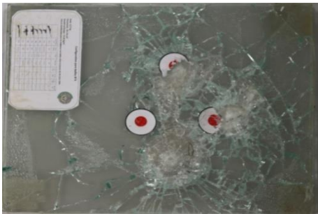
Figure IV. 30: Échantillon N°5 après trois tirs (arme AK-47, 7.62x39 mm).
