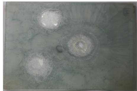
Figure IV. 31: Échantillon N°6 après trois tirs (Arme AK-47et BERETTA).
