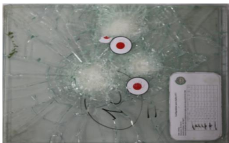
Figure IV. 32: Échantillon N°7 après trois tirs (arme BERETTA 9 mm)
