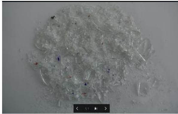
Figure IV. 14: Fragments dû aux chocs répétés sur le verre plats sous forme de sandwich (Verre/PVB/Verre ; 3 mm/0.76 mm/3 mm).
