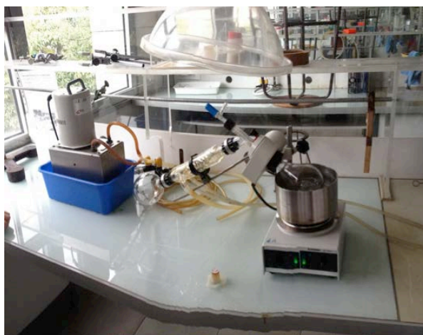
Figure 25: Evaporation des extraits par Rotavapor.
