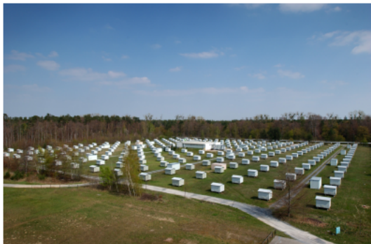
FIGURE 2.10 – Exemples des deux types de technique pour la détection des rayons cosmiques de haute énergie : le réseau de surface de KASCADE (à gauche) et les télescopes à fluorescence de HiRes (à droite) [85].
