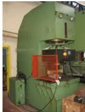
Figure.(II-1-3): Presse hydraulique utilisé pour le pressage des échantillons
