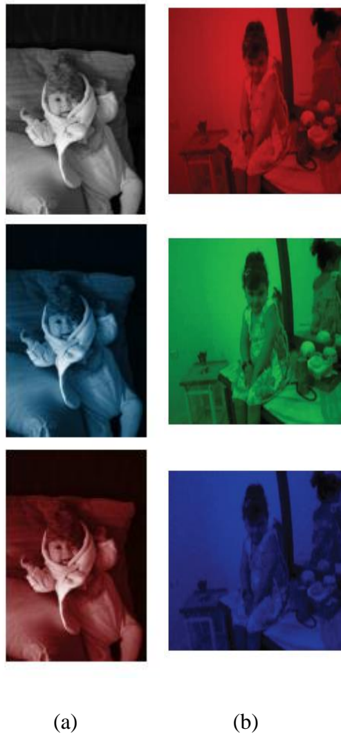
Figure 2.7 : Décomposition suivant les composantes YCbCr (a) et RVB(b).
