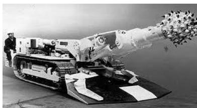
**Figure 2.4. Machine d'attaque ponctuelle Anderson Strathclyde RH25**
