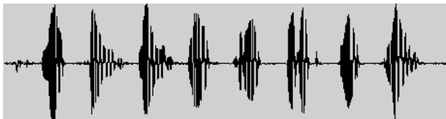
FIG 3.11 Exemple d'un signal acoustique résultant d'une dictée en mots isolés
