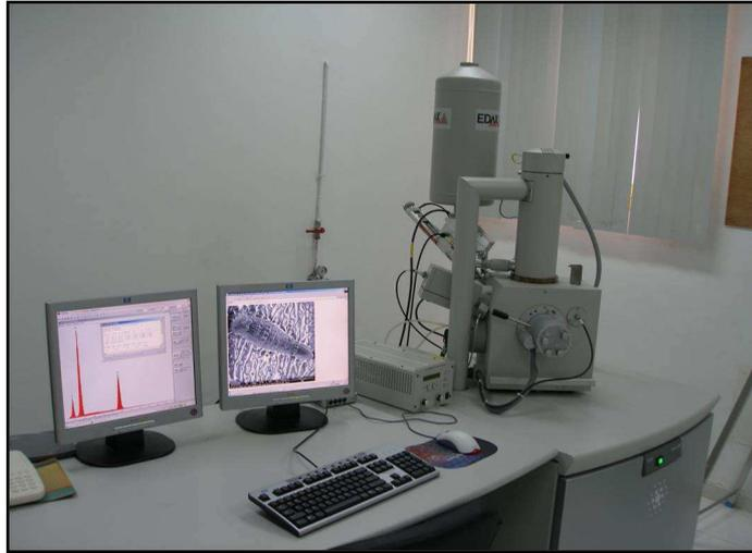
**Figure II.10 :** Microscope Electronique à Balayage FEI QUANTA 200.
