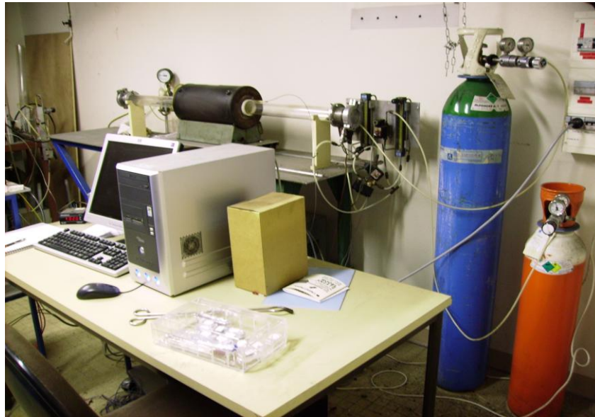
Fig.3.2 : Vue du four tubulaire de marque Adamel entièrement piloté par ordinateur du département de la Matière Condensée, Matériaux et Fonctions (MCMF) de l'institut Néel (CNRS, Grenoble) [134] .
