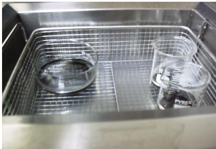
Fig.3.16: Nanoparticules d'YBCO/acétone dans des récipients en pyrex placés dans des bacs à ultrasons chauffants [134] .
