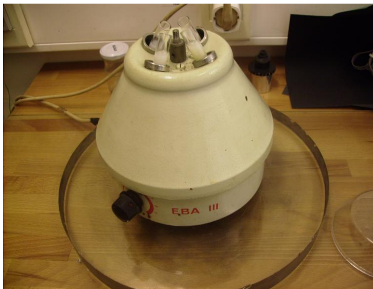
Fig.3.17: Vue de la centrifugeuse. Nous voyons quatre tubes à essai remplis d'un mélange acétone/poudre nanométrique de YIG [134] .
