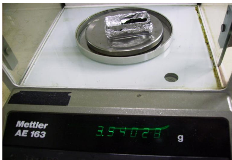
Fig.3.1: Balance de très grande précision de marque Mettler AE 163. Dans un premier temps, le creuset est pesé à vide. Ensuite, la balance est mise à zéro et enfin on ajoute le produit à peser (dans une figure, une poudre de \text{YBa}_2\text{Cu}_3\text{O}_{7.8} ). Comme on peut le voir, la balance indique une masse de 3.94027 g [134] .
