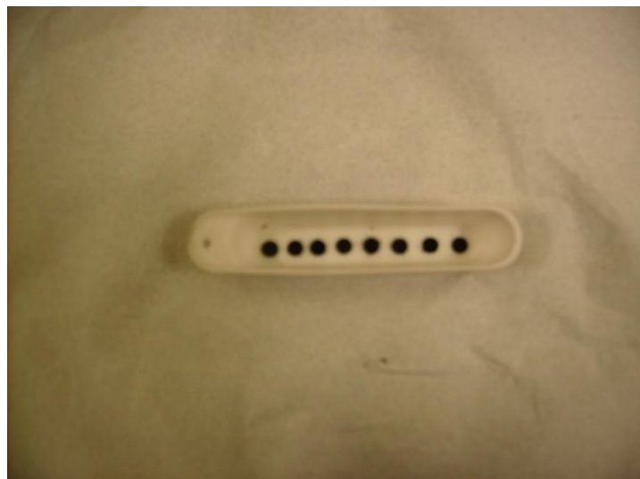
Fig.3.20 : Huit pastilles, de 5 mm de diamètre et d'un demi-millimètre d'épaisseur, placées dans un creuset en céramique [134] .
