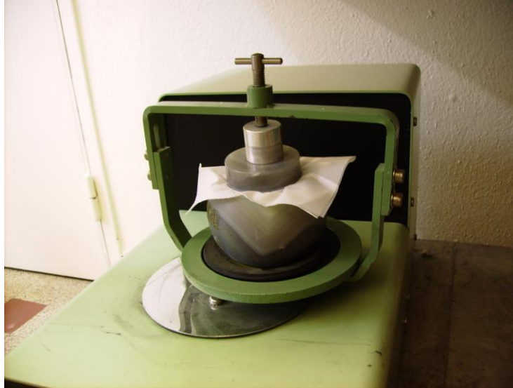
Fig.3.15: Vue du broyeur utilisé pour réduire la taille des grains à l'échelle nanométrique. Il est formé dans sa partie essentielle d'un cylindre en agate, à l'intérieur duquel s'agitent librement trois billes également en agate, d'un centimètre de diamètre [134] .
