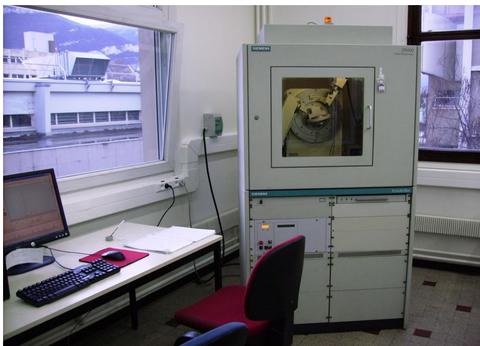
Fig.2.4 : Vue d'ensemble du diffractomètre à rayons X (D 5000) du département de la Matière Condensée, Matériaux et Fonctions (MCMF) de l'institut Néel (CNRS, Grenoble) [134] .
