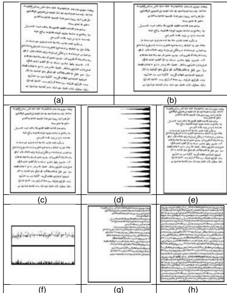
Figure 2.17. Prétraitements dans [FED 06], (a) Image binarisée de document; (b) Correction des angles de pente, (c) script horizontal, (d) projection horizontale, (e) normalisation des espaces inter-lignes, (f) projection verticale, (g) normalisation des espaces inter-mots et (h) remplissage de texte.
