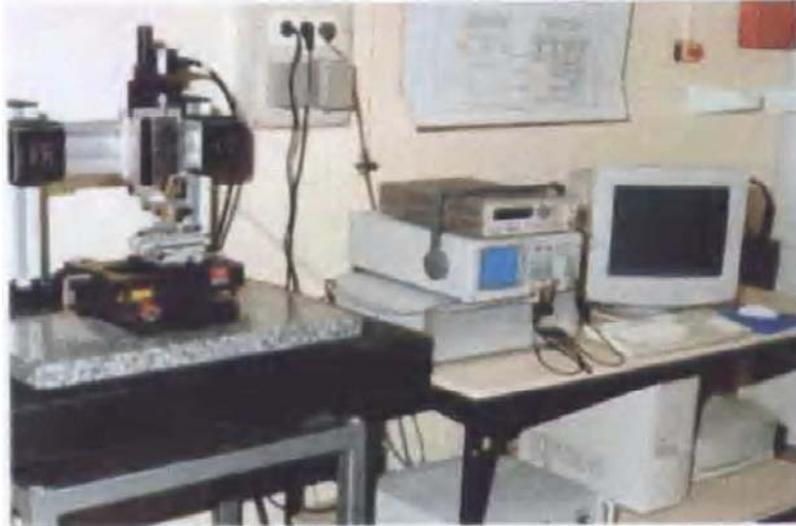
Figure II. 7: Vue d'un microscope acoustique fonctionnant en mode de réflexion
