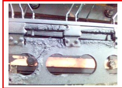
Figure II.1- Défaut de circuit magnétique « déformation »
