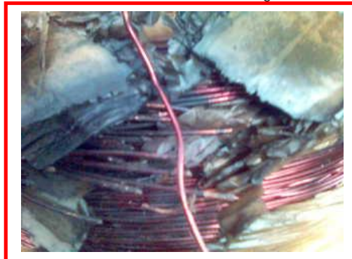
Figure II.4- Défaut de court circuit
