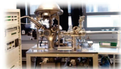
Figure. A3-17: Schéma de principe et photographie d'un spectromètre XPS utilisé.
