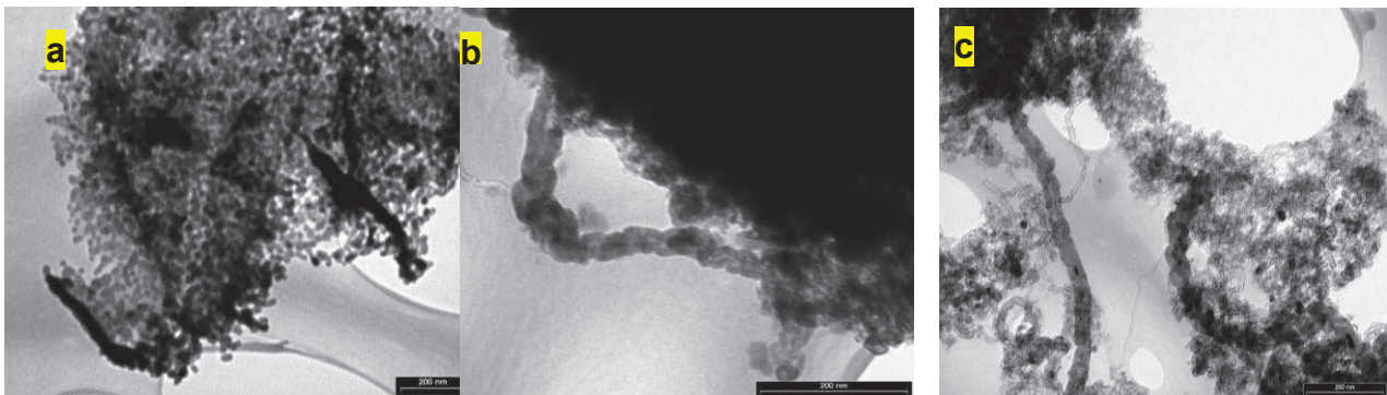
Figure. II.21: Images MET des NTCs obtenus à 800°C (mode de chauffage 1) : (a) 205 mL/min, (b) 300 mL/min et (c) 405 mL/min (température de la solution d'éthanol : 16°C).
