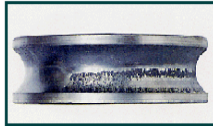
Fig-(III-24). Ecaillage de fatigue sur la bague intérieure d'un roulement à billes de contact angulaire
