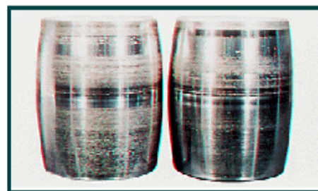
Fig-(III-31).Grippage sur les Rouleaux D'un roulement à rouleaux cylindrique
