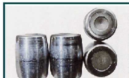
Fig-(III-28). Écaillage superficiel sur Rouleaux
