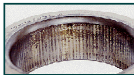
Fig-(III-35).Corrosion de contact sur la bague intérieur d'un roulement de Contact angulaire
