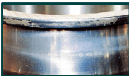
Fig-(III-27). Écaillage superficiel sur la bague Intérieure d'un roulement à rouleaux sphérique
