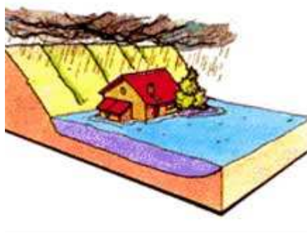
2. Par accumulation d'eau ruisselée
