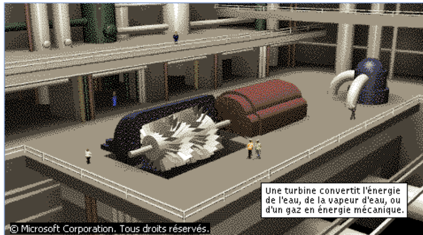
Figure A.4 : la turbine à vapeur 38
