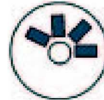
Figure 23 : Diffuseurs disposés sur un module (Type II)
