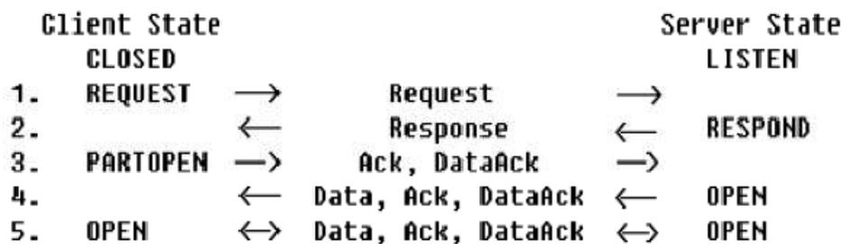
**Fig 11 :** Procédure d'établissement d'une connexion DCCP, [14]
