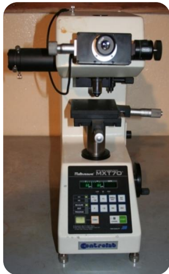
Figure III.8. Microduromètre MXT70 : a) photo du microduromètre, b) Empreinte.
