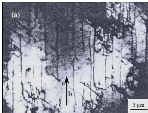
Figure I.6. Microstructure des dislocations vis dans le fer déformé [9].
