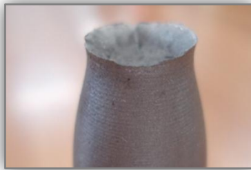
Figure IV.9. Faciès de rupture par traction des aciers : (a) 16NC6 et (b) 100C6 .
