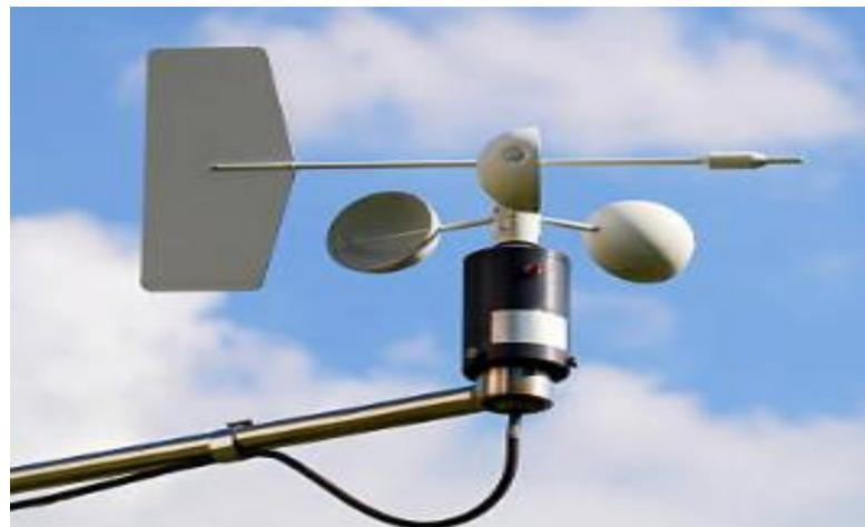
Figure I. 31 : anémomètre associe à une girouette
