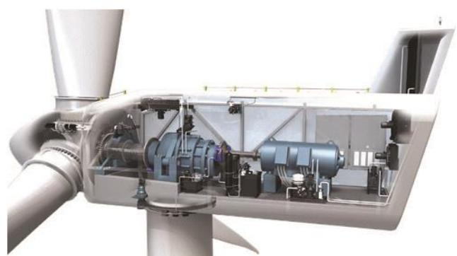
Figure I. 27 : Conception 3D du système de refroidissement Dans une éolienne
