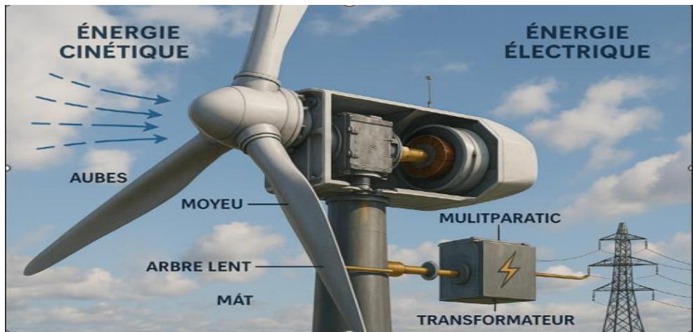
Figure I. 10 : Le principe de fonctionnement d'une turbine éolienne
