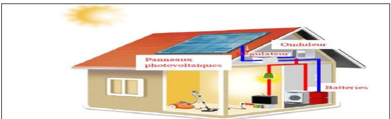
]Figure II . 7 : Les différents composants d'un système photovoltaïque autonome.[11]
