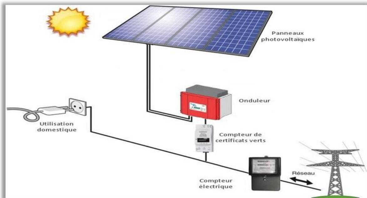
Figure. II.1: Système de conversion de l'énergie solaire en électricité.
