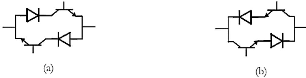
Figure II- 6: Topologie sans connexion central.
