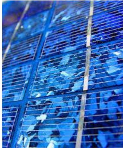
**Fig.9** : Cellule au silicium poly-cristallin.
