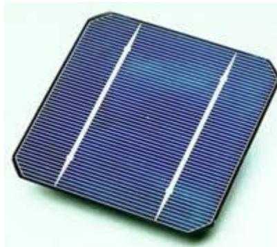
**Fig.8** : Cellule au silicium monocristallin.
