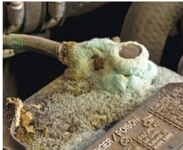
Figure 26: Phénomène de la sulfatation
