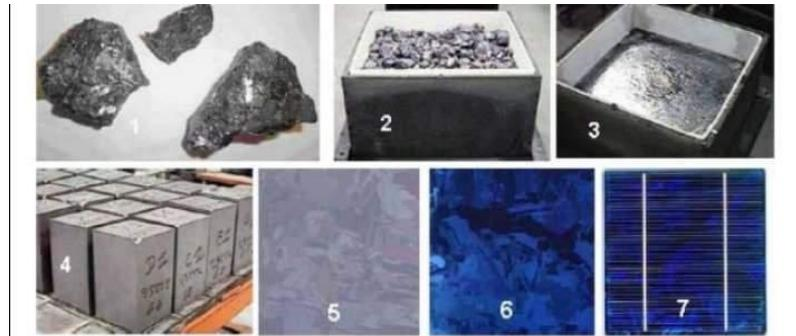
**Figure(II.3) :** Etape de fabrication des cellules
