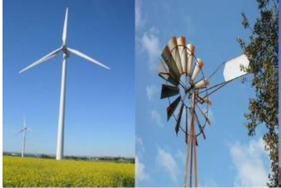
**Figure I.6:** Eolienne a axe horizontale. [10]
