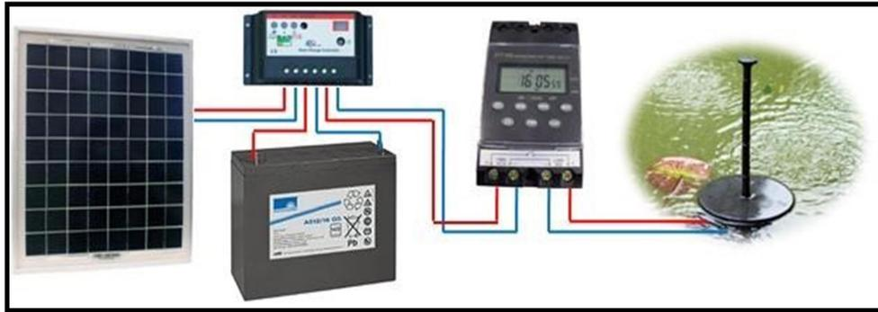
Fig I.4 Pompage photovoltaïque avec stockage d'énergie
