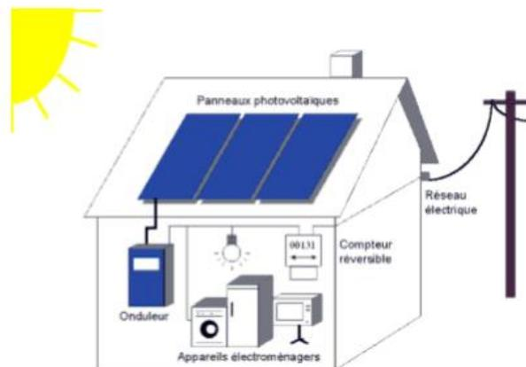
Fig. 1.8 : Fonctionnement du système solaire photovoltaïque
