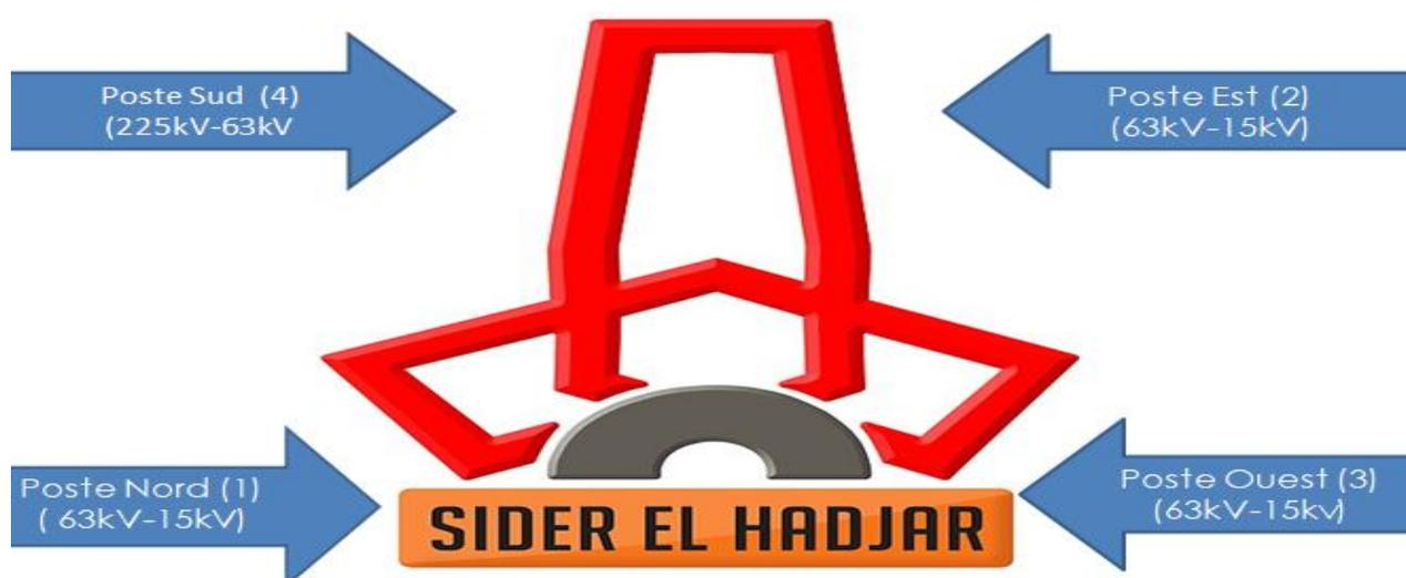
Figure 0-4 : description du réseau de distribution
