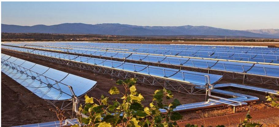
**Figure I.4. Panneau solaire thermodynamique**
