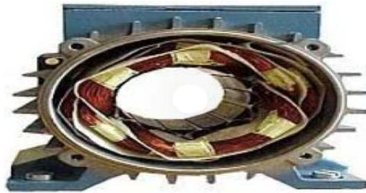
Figures I.9 : Le stator d'une machine asynchrone triphasée
