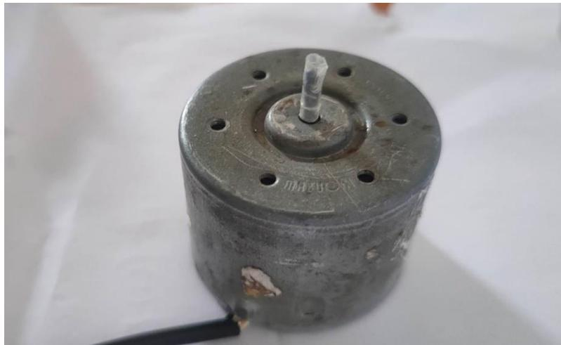
Fig 2.3 Photo du MCC utilisé
