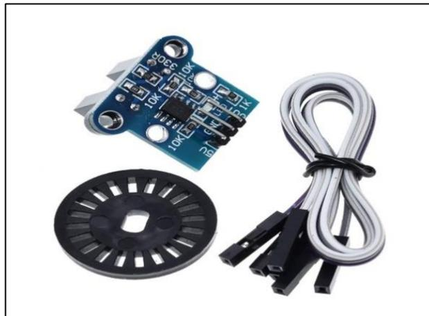
*Fig 4.5* Capteur de vitesse HC-020K
