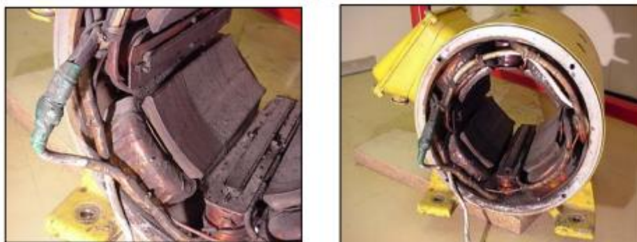
Figure V.11 : l'inducteur de la machine à courant continu
