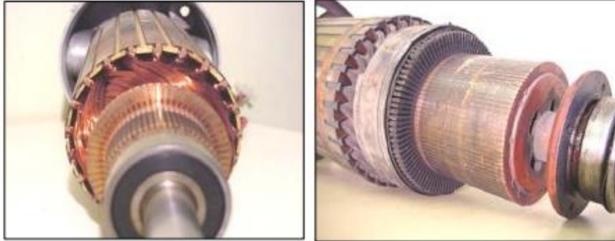
Figure V.12 : L'induit de la machine à courant continu
