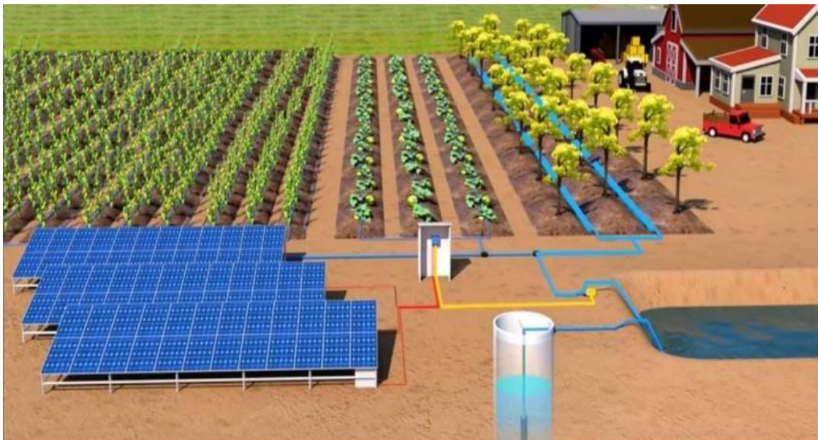
Figure VI.1 : Description du site de pompage photovoltaïque
