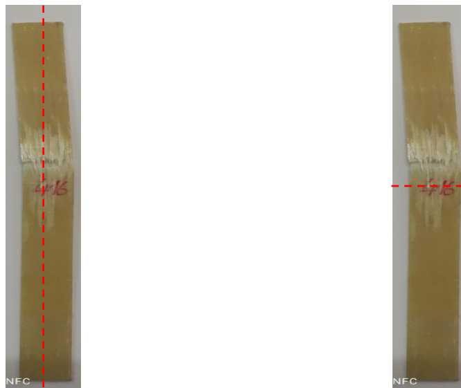
Figure 4.1 : Coupage linéaire CL et coupage tangentiel de l'éprouvette N°416.
