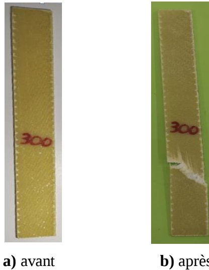
Figure 3.12: L'éprouvette fibre de verre sergé (N°300) avant et après l'essai de traction.
