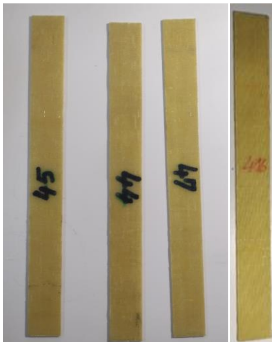
Figure 3.7 : Eprouvettes de type Fibre de verre unidirectionnel des angles 0^{\circ} - 90^{\circ} - 90^{\circ} - 0^{\circ} .
