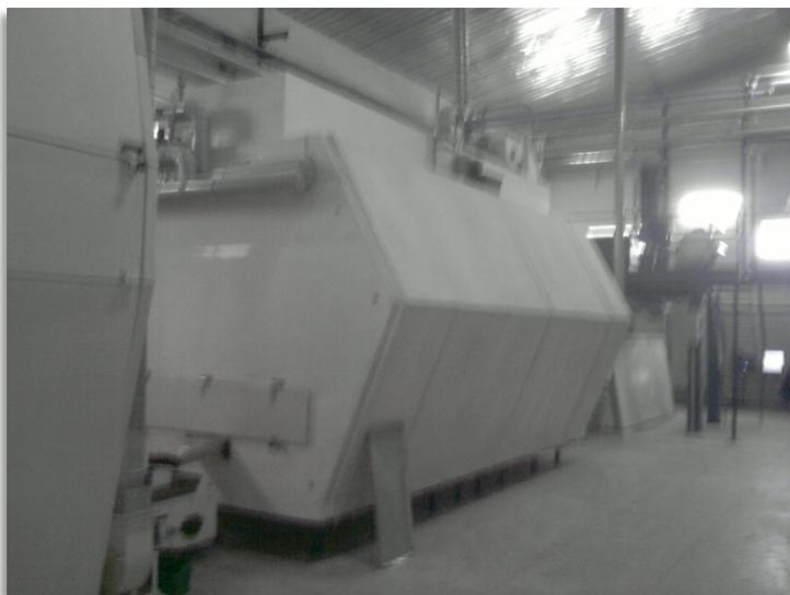
Fig.I.14: La machine de pré séchage
