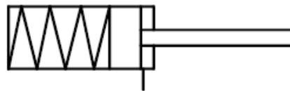
Fig.III.14: Symbole du vérin à traction.
