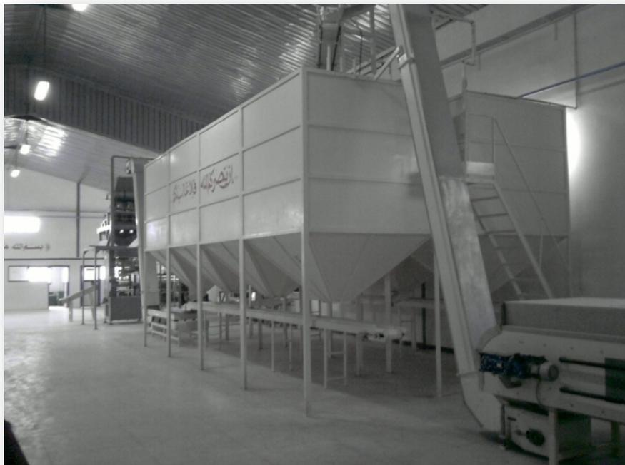
Fig.I.20: L'élévateur n°3 et les silos de stockage
