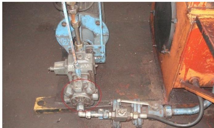
Figure 1.9-Pompe à pistons radiaux du banc d'essai
