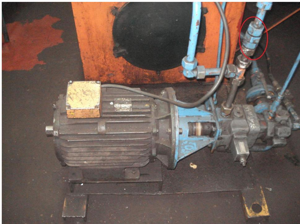
Figure 1.13-Clapet anti-retour du banc d'essai
