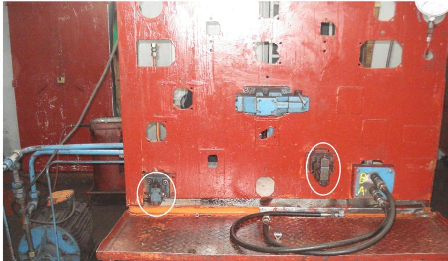
Figure 1.11-Les limiteurs de pression du banc d'essai
