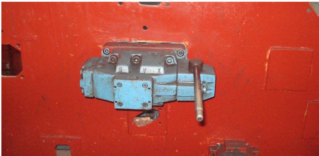
Figure 1.15- Distributeur 4/2 manuel du banc d'essai
