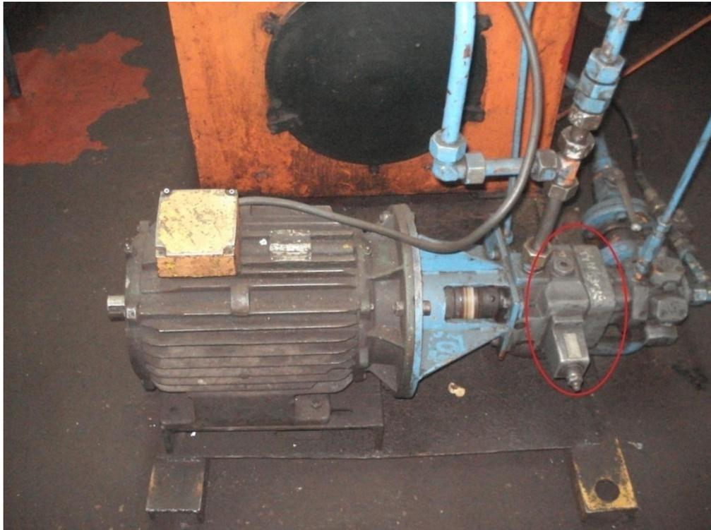
Figure 1.6-Pompe à palettes du banc d'essai
