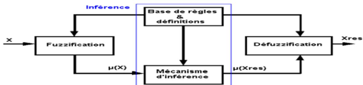
Figure 2.9 : Structure interne d'un régulateur par logique floue
