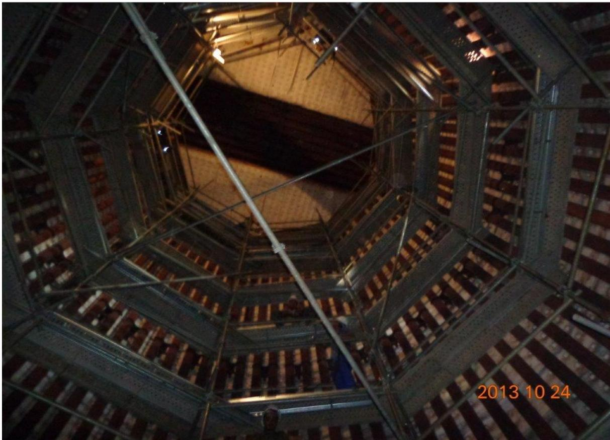
Figure 27 : Image réelle de la zone de radiation du four 100-F-103
