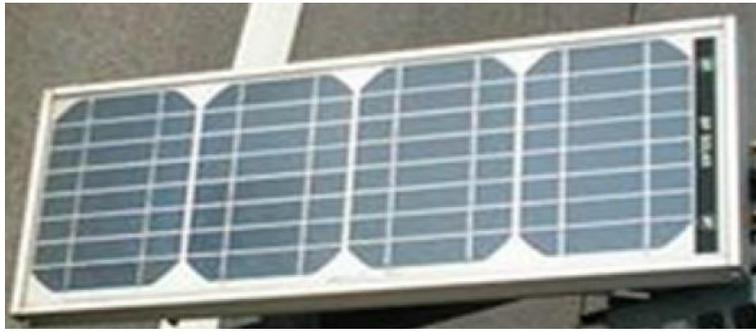
Fig.II.13 module solaire PV
