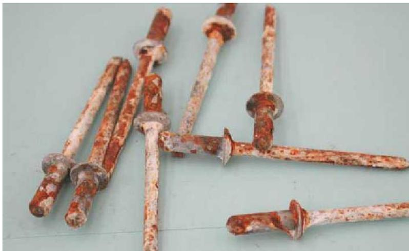
**Figure 11 : Corrosion chimique.**
