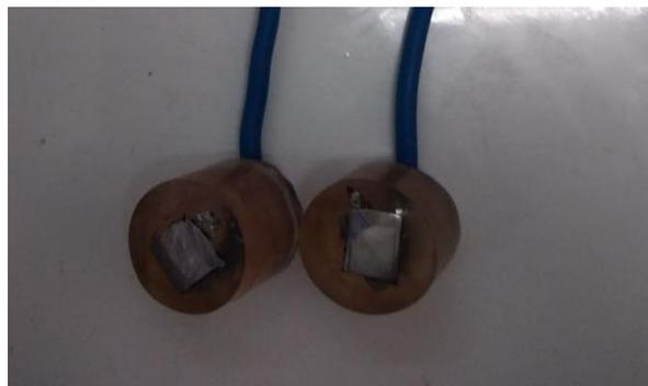
**Figure 19 : Echantillon utilisés dans les essais de corrosion.**
