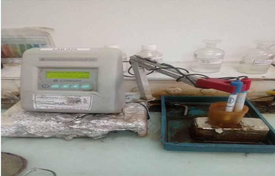
**Figure 09 : Conductimètre de type CRISON GLP 31.**
