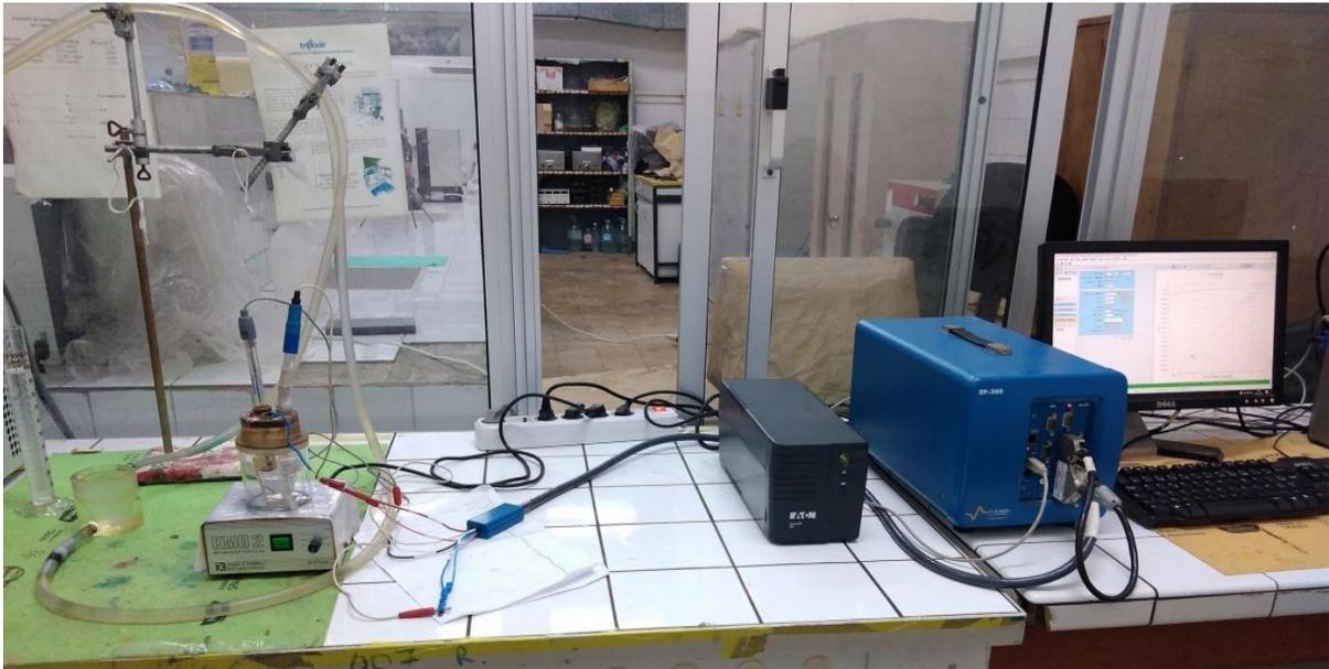
**Figure 21 : Montage des Essais de Corrosion Accélérée**
