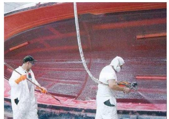
figure1. 9 Projection simultanée
