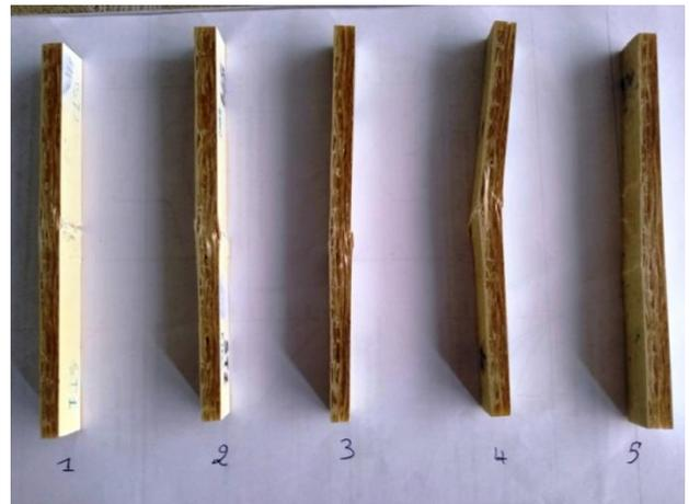
figure3. 8 Eprouvettes après essais de flexion statique
