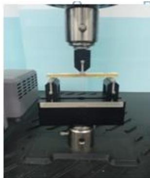
figure3. 7 Emplacement de l'éprouvette.
