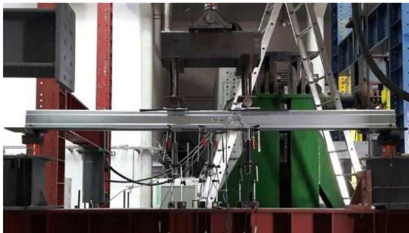
Figure I- 27 : Essai sur le modèle de poutre super-oméga.
