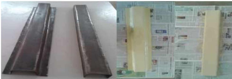
Figure III-29 : Présentation des modèles avant et après galvanisation.
