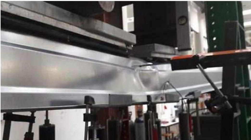
**Figure I- 29:** voilement locale de la poutre super-oméga
