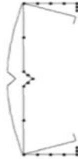
**Figure I-24 :**Instabilité distorsionnelle d'une section C avec raidisseur d'âme
